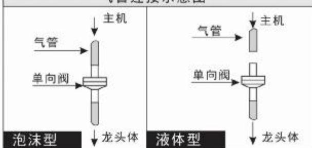
气管连接示意图
